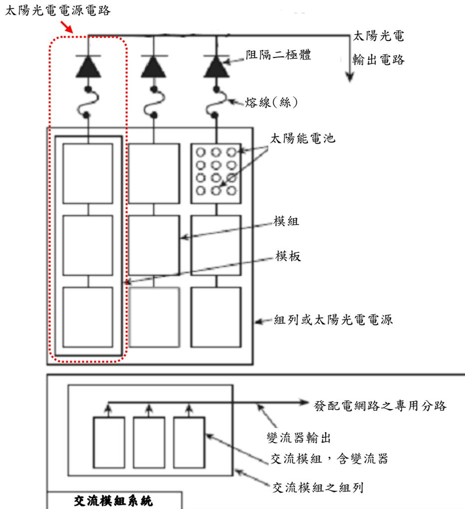
註：本圖僅供辨識太陽光電發電系統組件、電路及連接之方式，不含隔離設備、系統接地、設備接地之說明，亦不強制所有太陽光電發電系統按此圖例設計施作。
