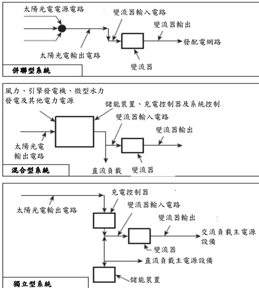
註：本圖僅供辨識太陽光電發電系統組件、電路及連接之方式，不含隔離設備、過電流保護、系統接地、設備接地之說明，亦不強制所有太陽光電發電系統按此圖例設計施作。
